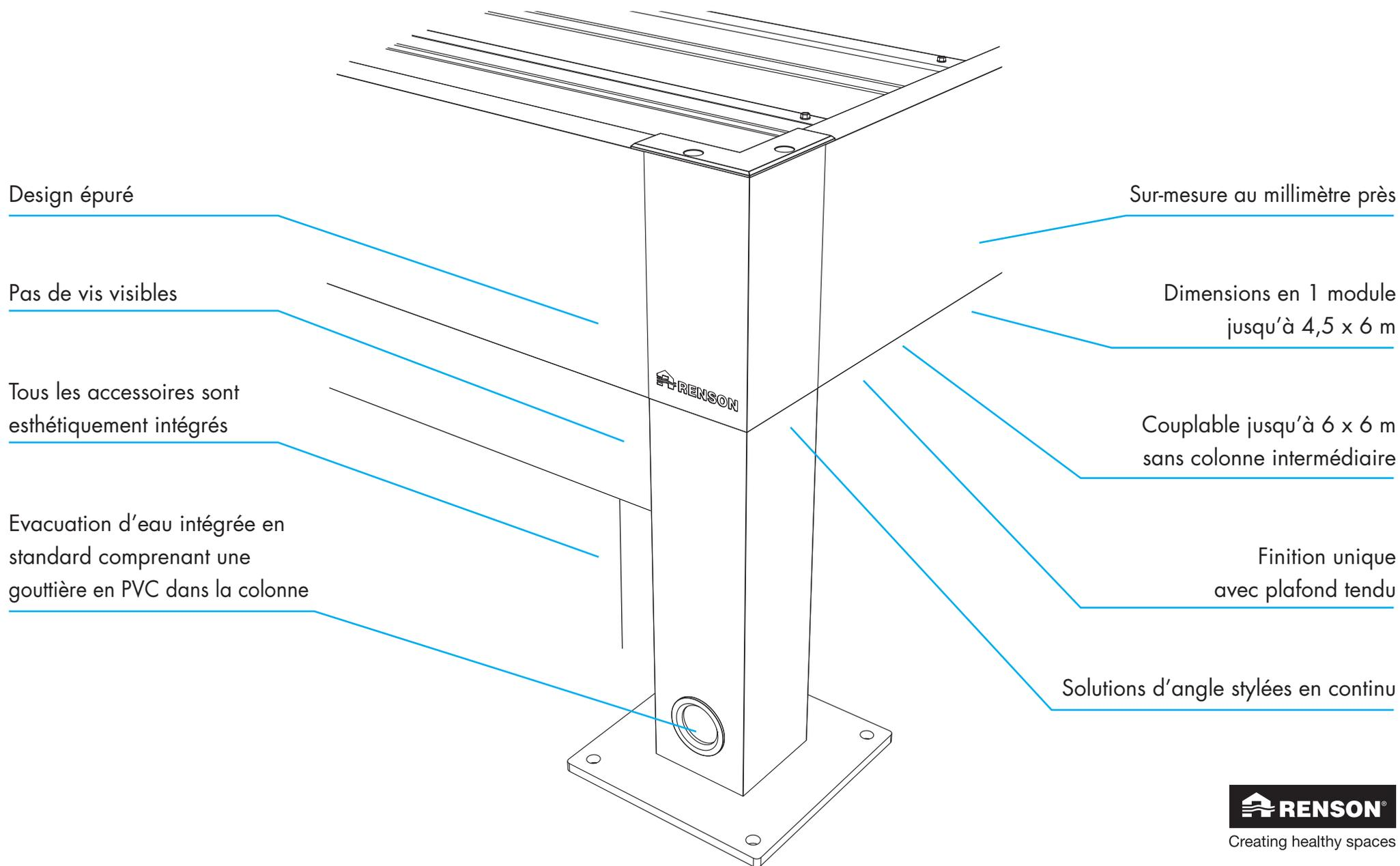
Passage/évacuation d'eau dans les angles pour une étanchéité parfaite
